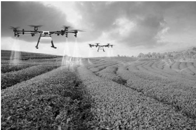
Obr. 12 Autonómne drony pri aplikácii postreku [9]
